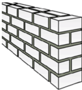
Einschalige Mauer (Quelle: BAUMARKT_191108, Lemma ,Sichtmauerwerk‘)
