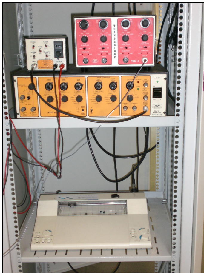
Abb. 14: Originalabbildung des Verstärkers inkl. Reizgerät und Schreiber
