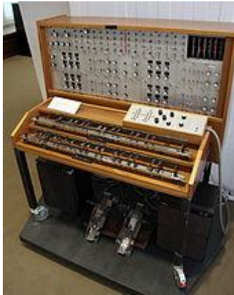
Abbildung: 11 Auf einem Mixtur-Trautonium Modell Berlin, 1955, wurden zahlreiche Soundeffekte gemischt, dieses Modell steht im Instrument Museum Berlin
