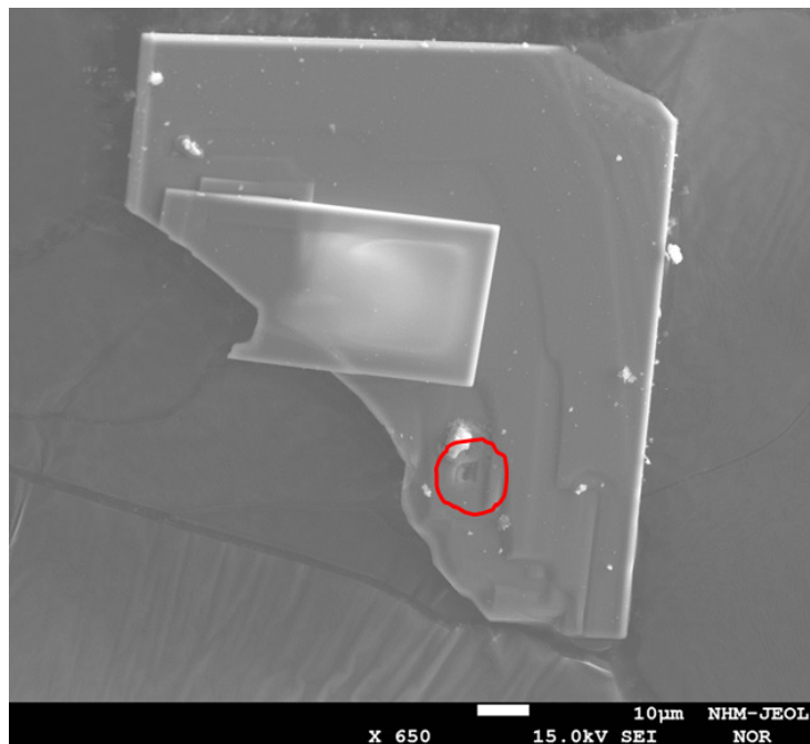
Abbildung 8: Die durch den Elektronenstrahl beschädigten Lannonit Plättchen. (Messpunkt mit Kreis gekennzeichnet).
