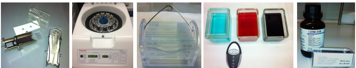
Abbildung 11: verwendeten Materialien und Geräte zur Färbung [Privat, 2013] Von links nach rechts: Objektträger, Klammer, Filterpapier, Trichter, Cytopsin, Färbewanne, Entellan
