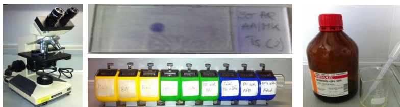
Abbildung 12: Verwendete Materialien und Gräte zum Mikroskopieren Von links nach rechts: Mikroskop, gefärbter Objektträger, Auszählhilfe, Immersionsöl [Privat, 2013]
