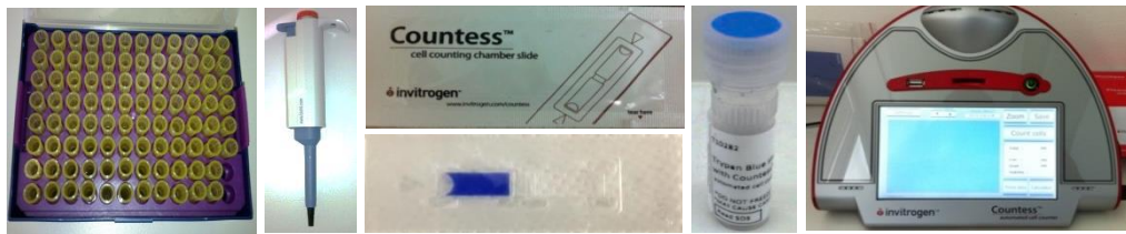
Abbildung 9: verwendeten Materialien und Geräte zur Zellzahlbestimmung [Privat, 2013] Von links nach rechts: Spritzen, Pipette, Countess cell chamber slide Verpackung bzw. in Gebrauch, Trypanblau, Countess.
