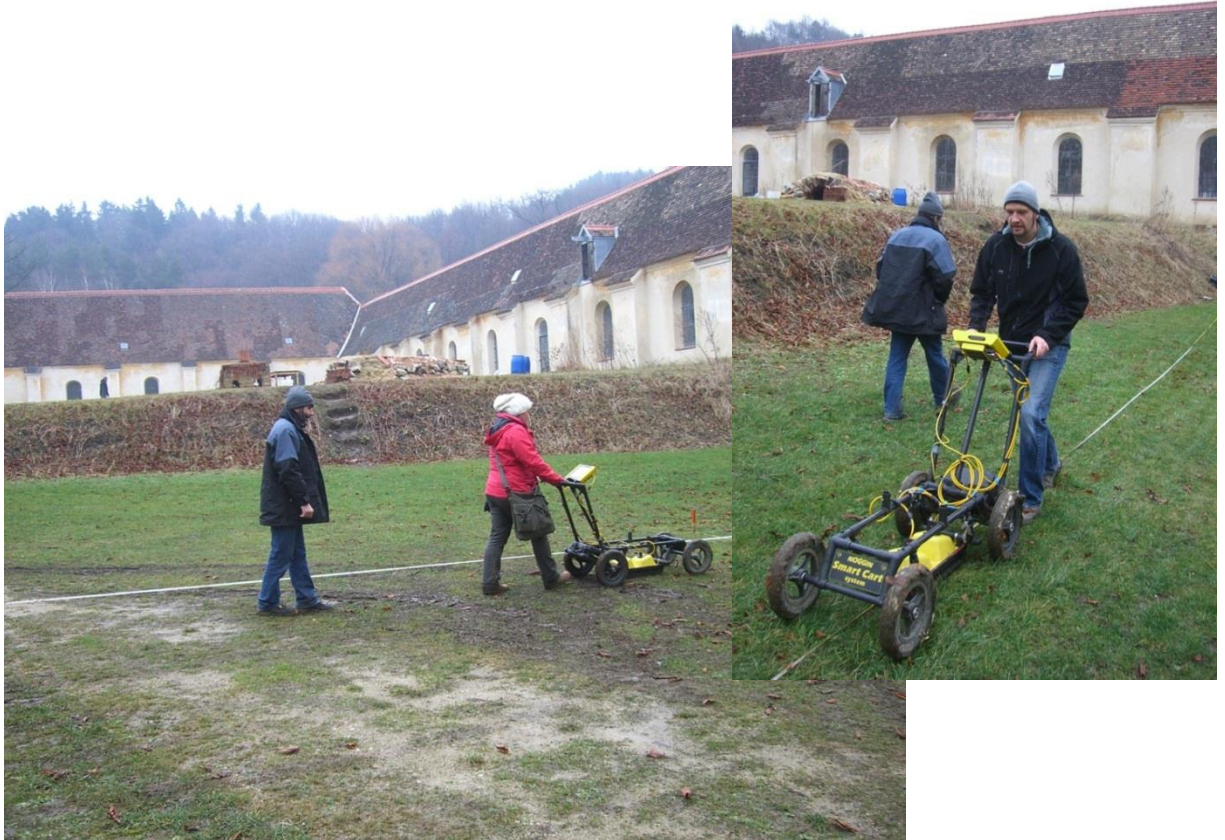
Abbildung 44: Durchführung der Bodenradar-Messungen im Kreuzgarten
