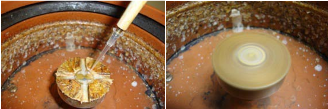
Abbildung 24: Sipncoat- Technik: die Lösung des Präpolymers wird mit einer Mikropipette auf die Elektrode aufgetragen und auf einer Lackschleuder mit hoher Umdrehungszahl abgespinnnt
