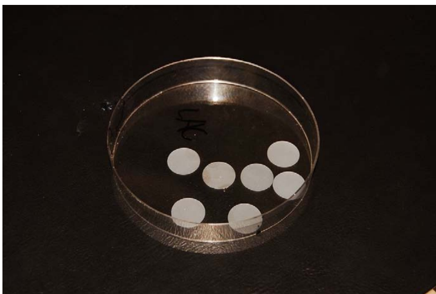
Abbildung 17: Kommerziell erhältliche AT-10 MHz-Quarzplättchen in einer Petrischale. Sie haben einen Durchmesser von 14 mm und besitzen eine Dicke von 168 \mu\text{m} .
