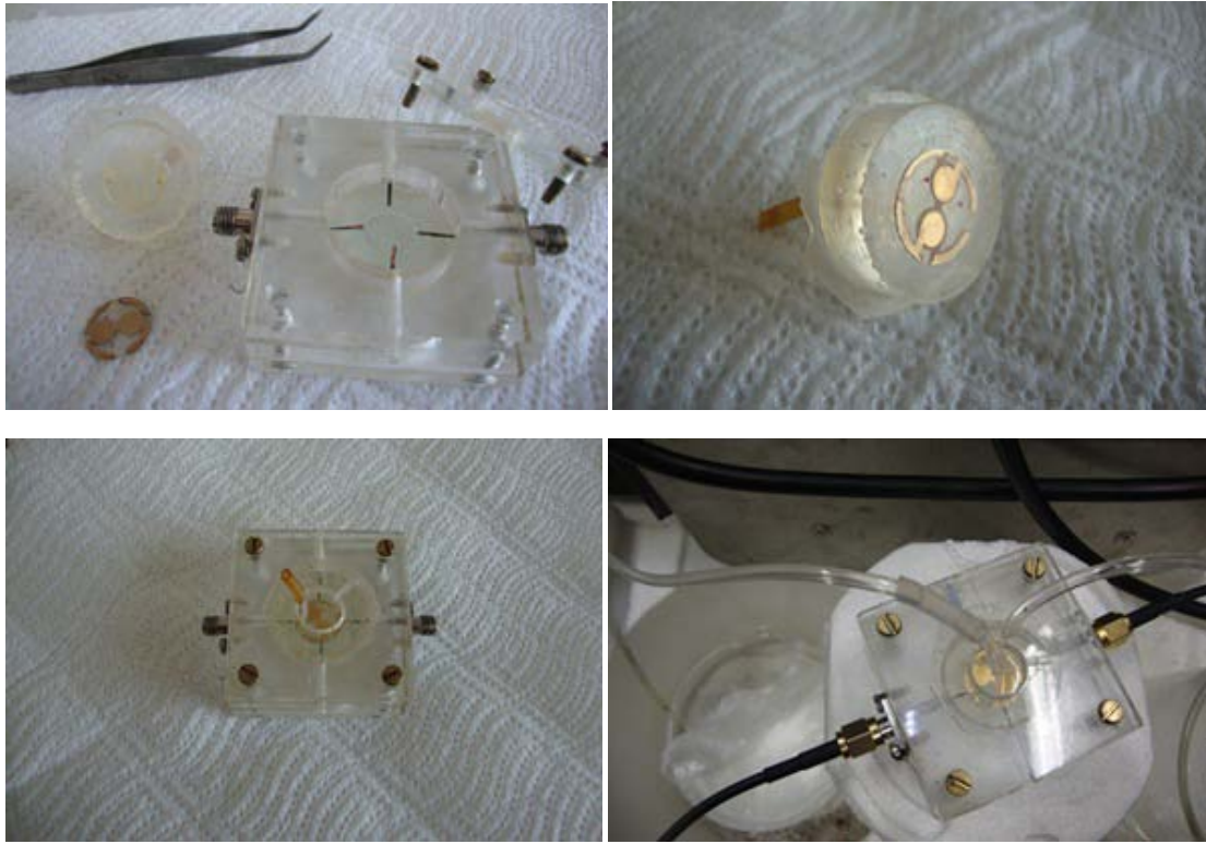
Abbildung 25: Die Messzelle für Schwingquarzmessungen in der flüssigen Phase besteht aus diesen gezeigten Einzelteilen: Silikondeckel mit Ein- und Auslassschlauch, Silikonboden, Plexiglasgehäuse mit Schraubplatte, Kupferelektroden und Kontaktierungsaufsätze (Bild 1). Der Messraum entsteht, wenn der Quarz an den Silikondeckel mit dem Hohlraum gepresst wird (Bild 2). Die messbereite Zelle mit einem Aufsatz für die Injektionsmessung (Bild 3). Eine angeschlossene Messzelle im kontinuierlichen Durchflussbetrieb (Bild 4).
