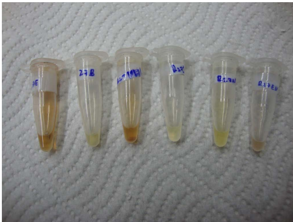
Abb. 62: Gleiche Polystyrol/Polyvinylpyrrolidon-Polymere Polymerzusammensetzung: 50 mg Divinylbenzol, 50 mg Vinylpyrrolidon, 5 mg AIBN, 200 mg THF als Lösungsmittel, 70°C rühren bis Gelpunkt, geprägt mit den Templaten Ergotamin, Brucin, Methylergometrin, Indolessigsäure, Nicergolin und Ergometrin (v.l.n.r.).
