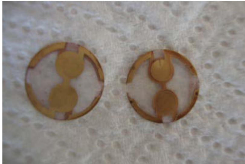
Abbildung 18: Quarze, die zur Messung im 2- Kanal- Modus konzipiert werden, besitzen 2 Goldelektrodenpaare. Das eine Elektrodenpaar fungiert als Messelektrode und das zweite als Referenzelektrode. Jedes Elektrodenpaar besitzt sowohl eine Goldelektrode an der Oberseite und eine an der Unterseite. Für Quarze der Flüssigphase sind die kleineren Elektroden der Unterseite getrennt, während die größeren Elektroden der Oberseite verbunden sind.
