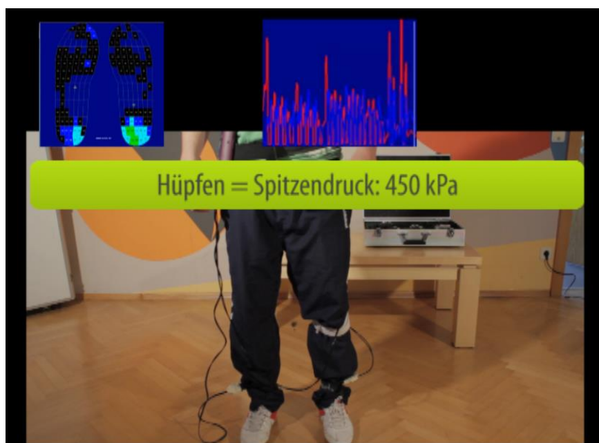
Abbildung 68: Screenshot vom maximalen Spitzendruck beim Hüpfen mit Hallenschuhe (Druckmessfolie)
