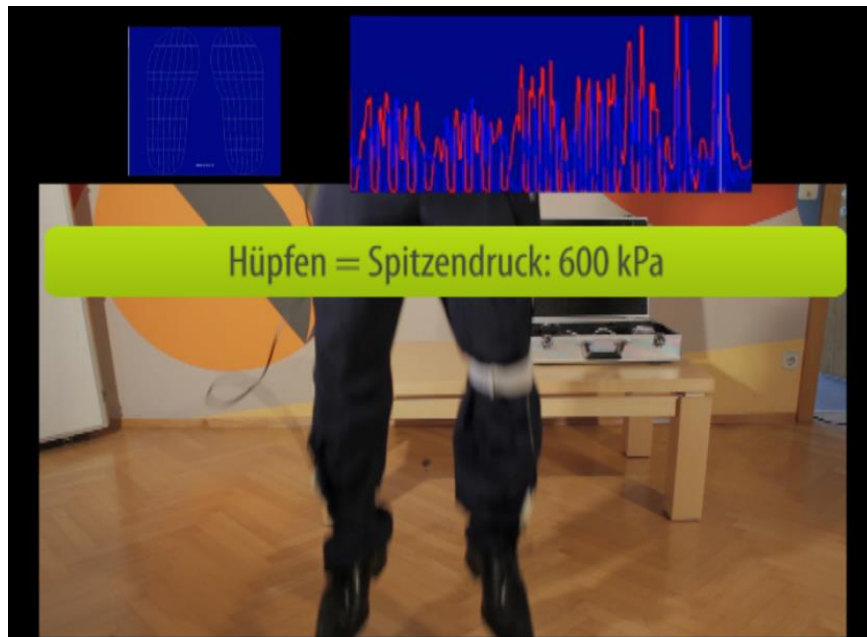
Abbildung 69: Screenshot vom maximalen Spitzendruck beim Hüpfen mit Absatzschuhe (Druckmessfolie)
