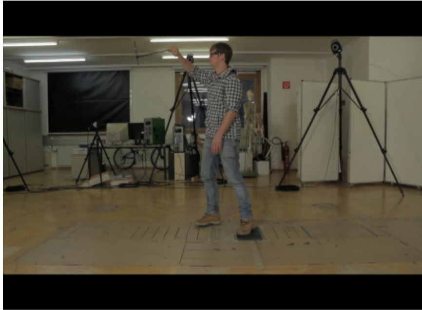
Abbildung 30: Screenshot der Kalibrierung mit dem Kalibrierstab (Motion Capture)
