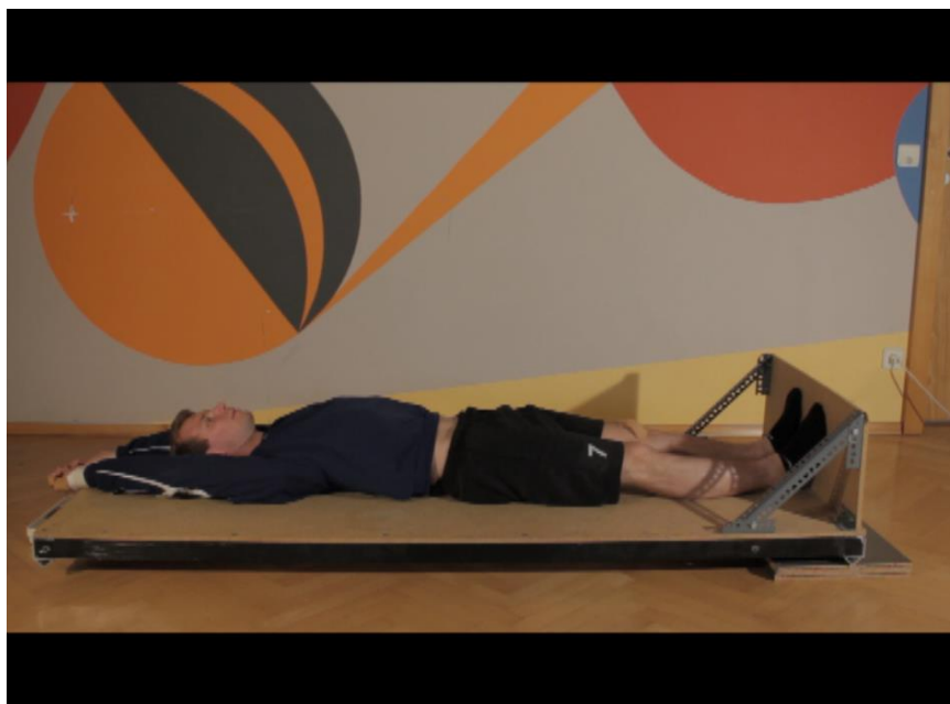
Abbildung 96: Screenshot von der KSP-Bestimmung mit ausgestreckten Armen (KSP-Bestimmung)
