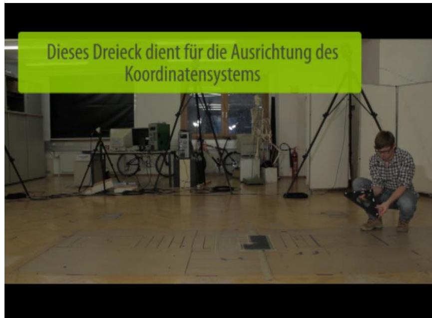
Abbildung 32: Screenshot der Koordinatenausrichtung mit dem Kalibrierdreieck (Motion Capture)
