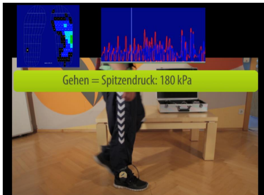
Abbildung 58: Screenshot der Messung beim Gehen (Druckmessfolie)
