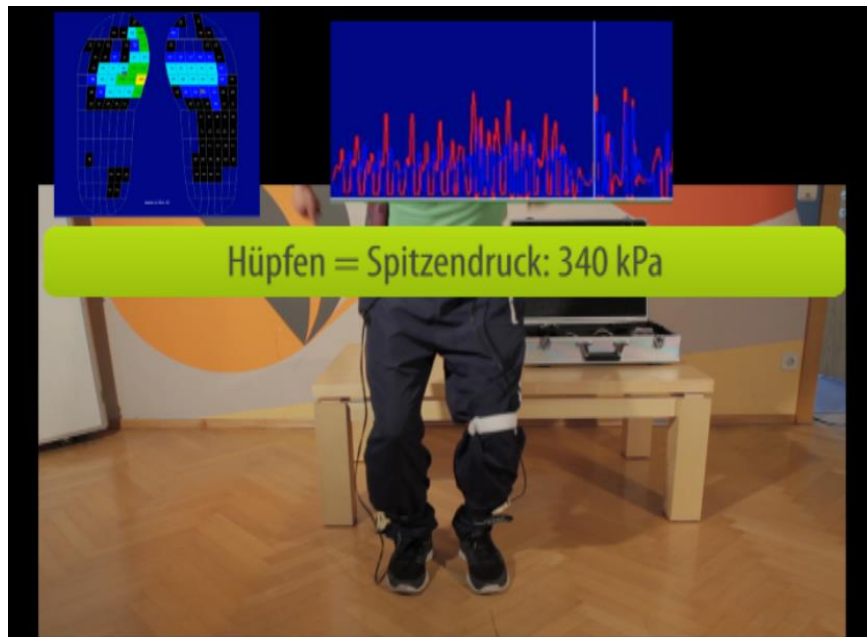
Abbildung 67: Screenshot vom maximalen Spitzendruck beim Hüpfen mit Laufschuhe (Druckmessfolie)
