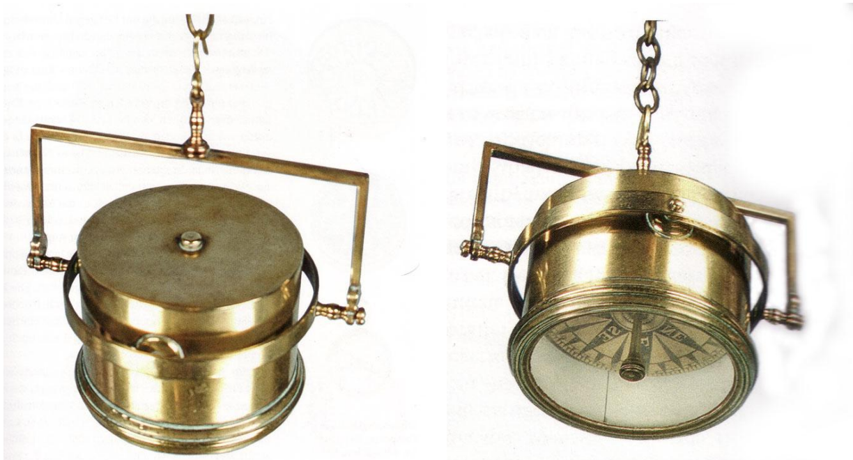
Abb. 9: Freischwinger Schiffskompass mit Kardanik
