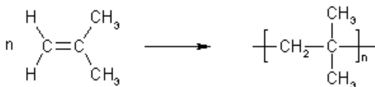
Abbildung 7: Links: das Monomer Isobuten, rechts: das Polymer Polyisobuten
