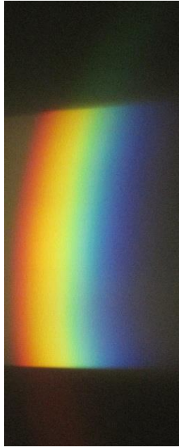
Abbildung 16: Roter (unten) und grüner (oben) Farbfilter verändern das Spektrum
