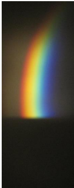
Abbildung 17: Eine grüne Folie absorbiert rotes Licht
