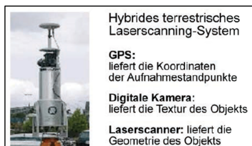
Abb. 15 Hybrides terrestrisches Laserscanning-System (aus RIEDL, RIEDL, MITTERMAIER (2012))
