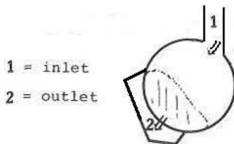
Abbildung 23: Luftstromführung im Trommelinnenraum des GC 750 Coater. 56
