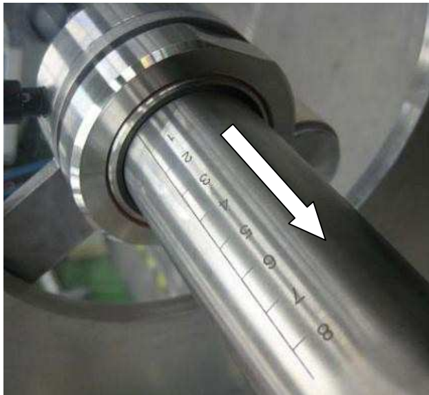
Abbildung 19: Eintauchtiefe des Düsenstocks.
