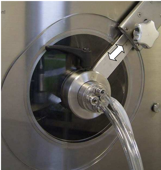
Abbildung 17: Graphische Veranschaulichung der Verstellbarkeit des Düsenstocks zum Kernbett.
