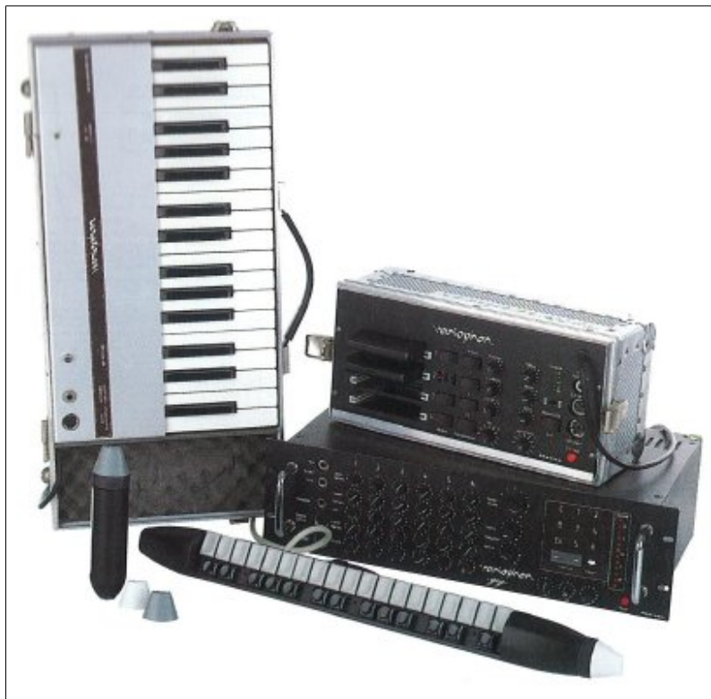
Abb. 4.4: Verschiedene Variophon-Komponenten: Die Musiccockpits für das Variophon-Spot mit zwei eingesteckten Klangfarbenmodulen (rechts), darunter das Variophon-Gig, mit der optionalen Klaviatur (links) samt eigenem Blaswandler und auswechselbaren Mundstücken, und in der Mitte das Tastenblasinstrument. (Becker 1995, S.92)
