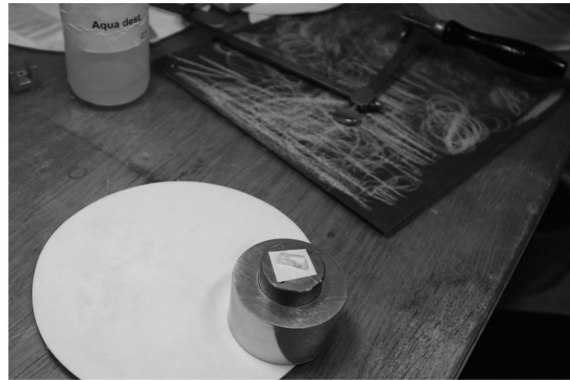
Abbildung 3.2: Probenpräparation: Schneiden (a) und Polieren (b) des Kristalls
