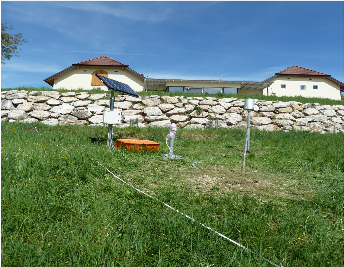
Abbildung 76: Lage des geoelektrischen Monitoringprofils unterhalb des Hauses (Foto: GBA, 2011)
