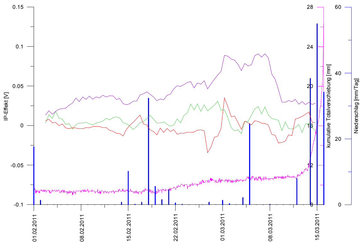
Abbildung 67: IP-Effekt vor der Verschiebung März 2011 der Elektroden 8-16 (rot), 56-60 (grün) und 68-70 (violett), verglichen mit Niederschlagswerten (blau)
