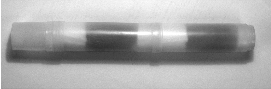
Abbildung 3.5.: Zwei aneinander gehängte, einsatzbereite Bestrahlungspatronen mit Verschlusskappe, die graphitbefüllten Ampullen (dunkle Gebiete) und die stoßdämpfende Baumwolle (helle Gebiete) sind eindeutig erkennbar
