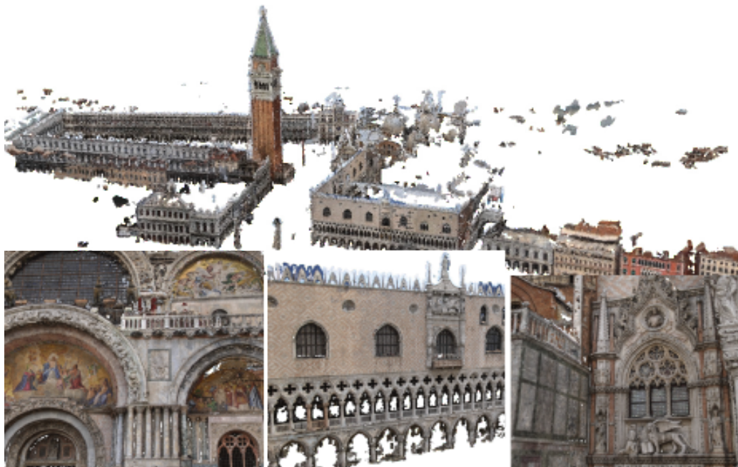
Abb. 4.1.: Structure from Motion: Punktwolke der Piazza San Marco (Venedig), 27.707.825 Punkte, rekonstruiert aus 13.703 aus dem Internet heruntergeladenen Bildern (Quelle: Furukawa u. a. 2010 )
