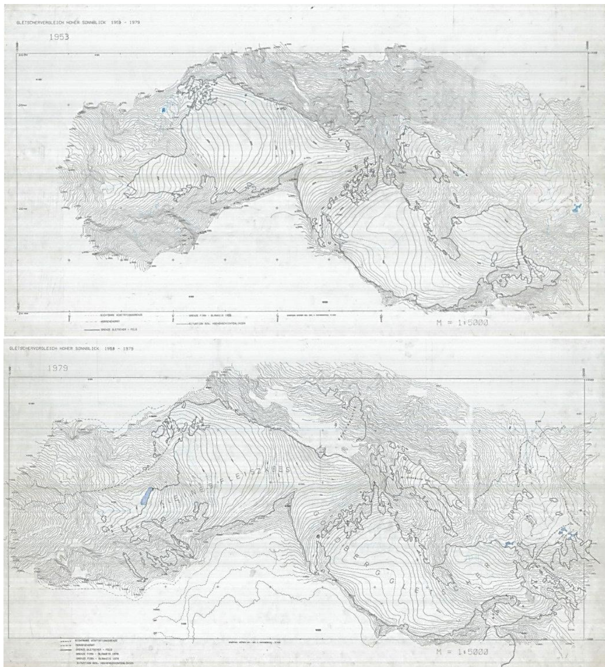
Abbildung 3-6 Höhenschichtpläne 1979 und 1953, Maßstab 1:5.000 (Quelle: Stereophotogrammetrische Höhenschichtpläne, Institut für Photogrammetrie und Fernerkundung, Technische Universität Wien, 1981)
