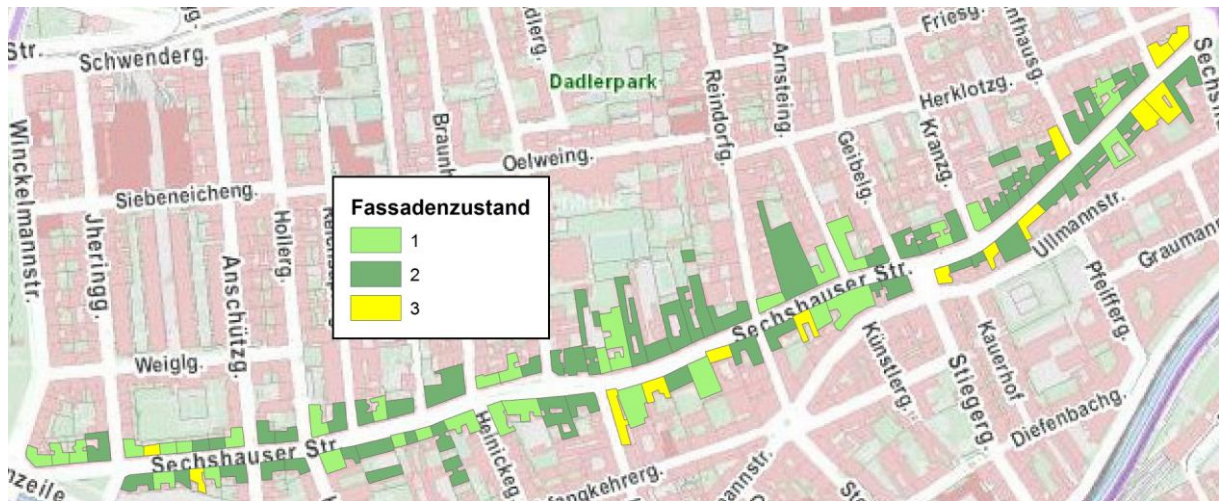
Abbildung 26: Fassadenzustand in der Sechshauserstraße (WIEN KULTURGUT & LIPPL 2012)
