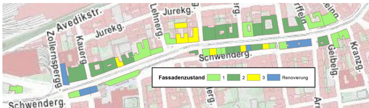
Abbildung 22: Fassadenzustand Mariahilfer Straße West (WIEN KULTURGUT & LIPPL 2012)
