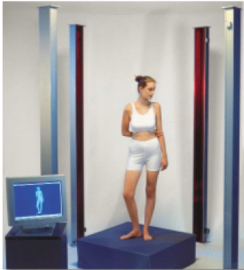
Abb. 14: Vitus smart Laserscanner (Vitronic, 2011, S. 9).
