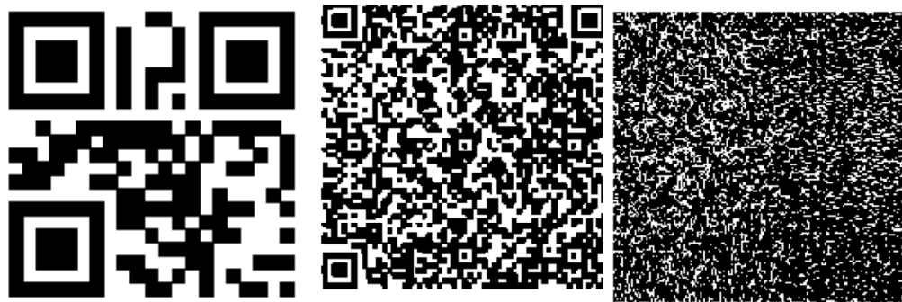
Abbildung 4: Veränderung des QR-Codes bei steigender Datenmenge
