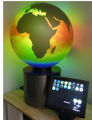
Abbildung 1: Taktiler Hyperglobus mit Touchscreen-Interface (Quelle: [GLO-12aa])
