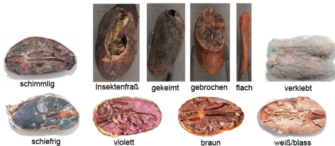
Abbildung 14: Kakaobohnen in verschiedenen Fermentationsstadien beziehungsweise Defekten (typische Schnitt-Test Beispiele) [modifiziert nach LIEBEREI und ROHSIUS, 2010]
