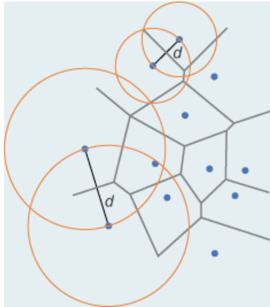
Abbildung 15: Konstruktion von Thiessen Polygone (Quelle: HAGGET et al. [HAG-77] in http://www.gitta.info/Accessibilit/de/html/UncProxAnaly_learningObject4.html )
