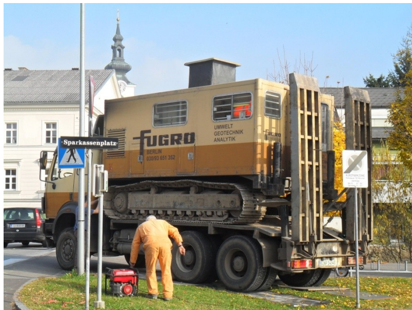
Abbildung 59: Direct - Push – Bohrgerätschaft (eigene Quelle)
