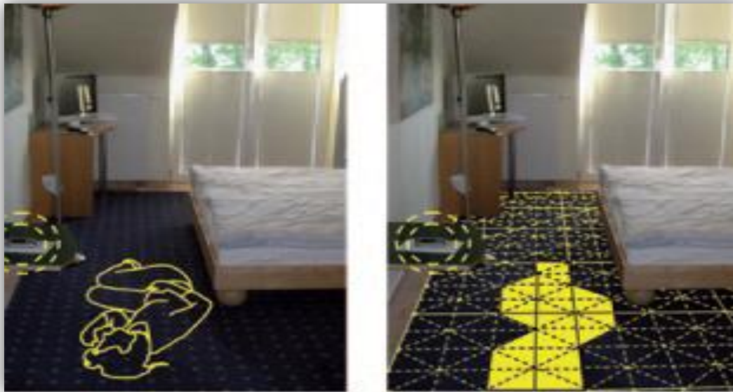
Abbildung 21: Sturzerkennungsteppich „SensFloor®“ (Steinhage et al., 2011, S. 42).
