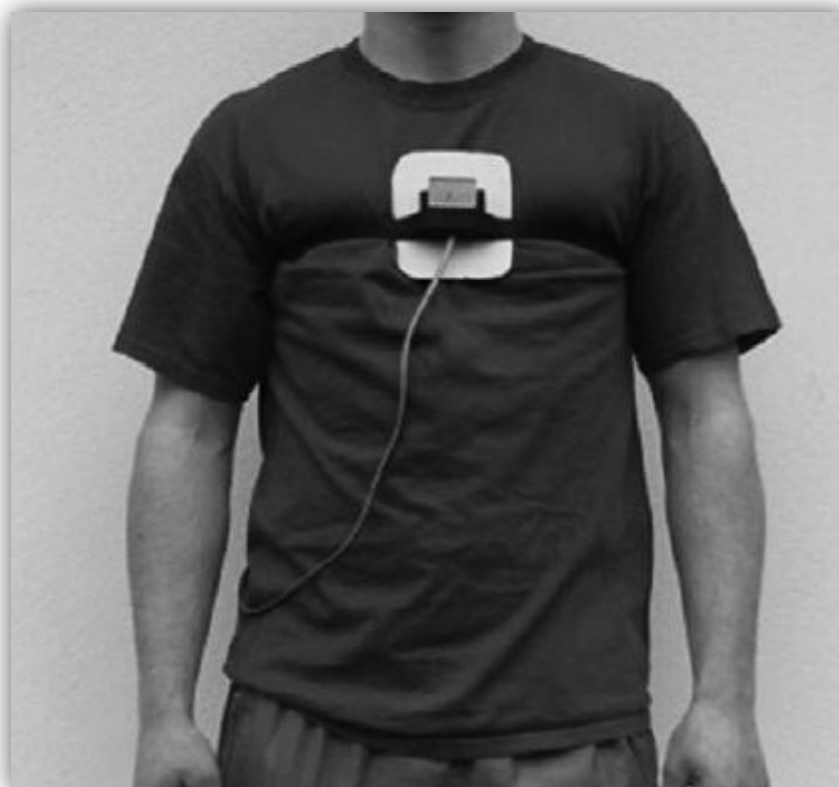
Abbildung 15: Sternale Anbringung des Beschleunigungssensors
