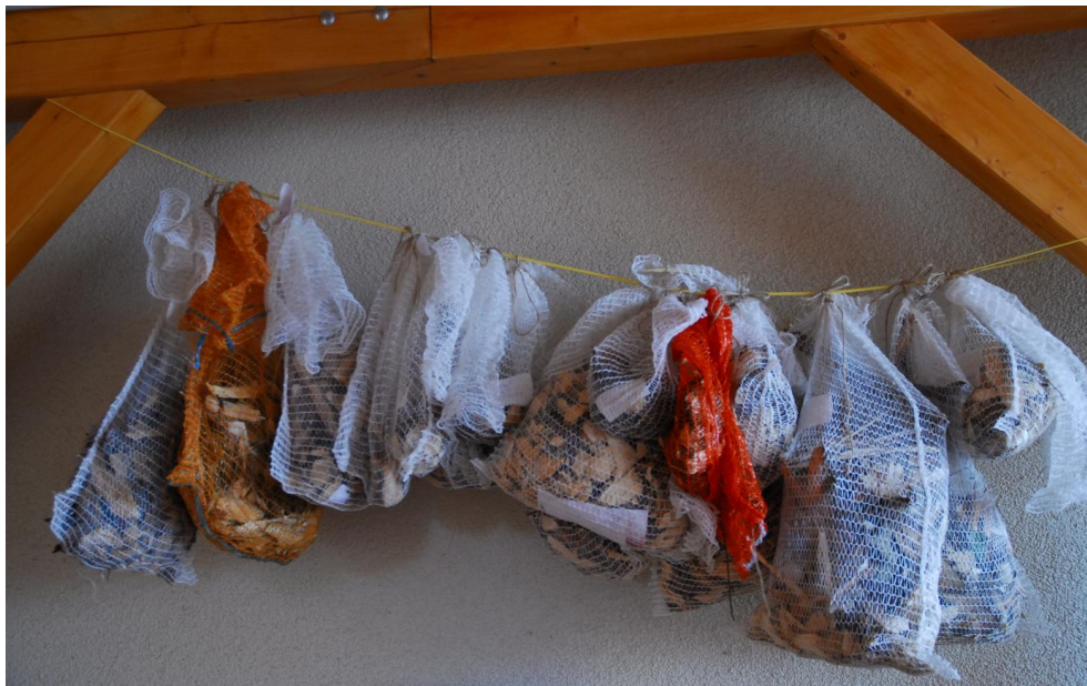
Abbildung 7: Die Holzspäne wurden in Luftdurchlässigen Säcken getrocknet
