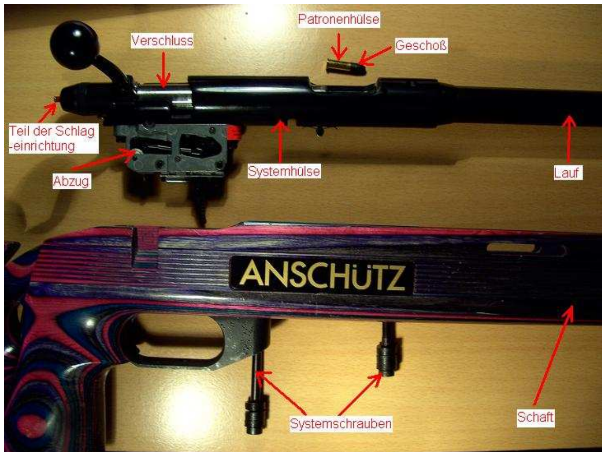
Abb. 1.1: Exemplarische Darstellung der Hauptkomponenten eines Kleinkalibersportgewehres am Beispiel eines Wettkampfgewehres ANSCHÜTZ Mod. 1907.
