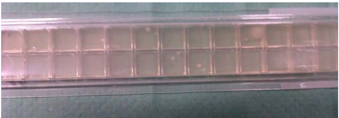
Abb. 20. Agarstreifen mit Keimen, nach Bebrütung (Foto: Banovac)
