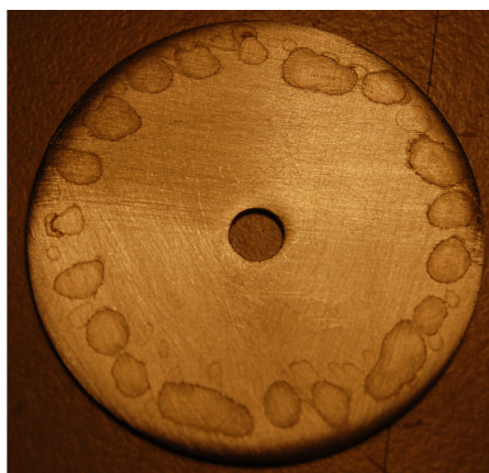
Abbildung 5.2: Probenplatte aus Aluminium mit am Rand getrockneten Tropfen (Dried-Droplet-Methode) einer Matrix/Analyt-Mischung bestehend aus 2,5-DHB und Hemoglobin.
