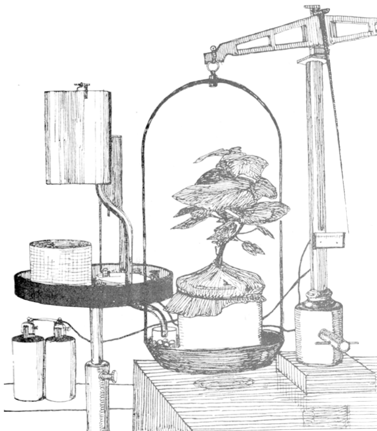
Abb. 14: Selbstregistrierendes Transpirometer von GANONG (BURGERSTEIN 1920)
