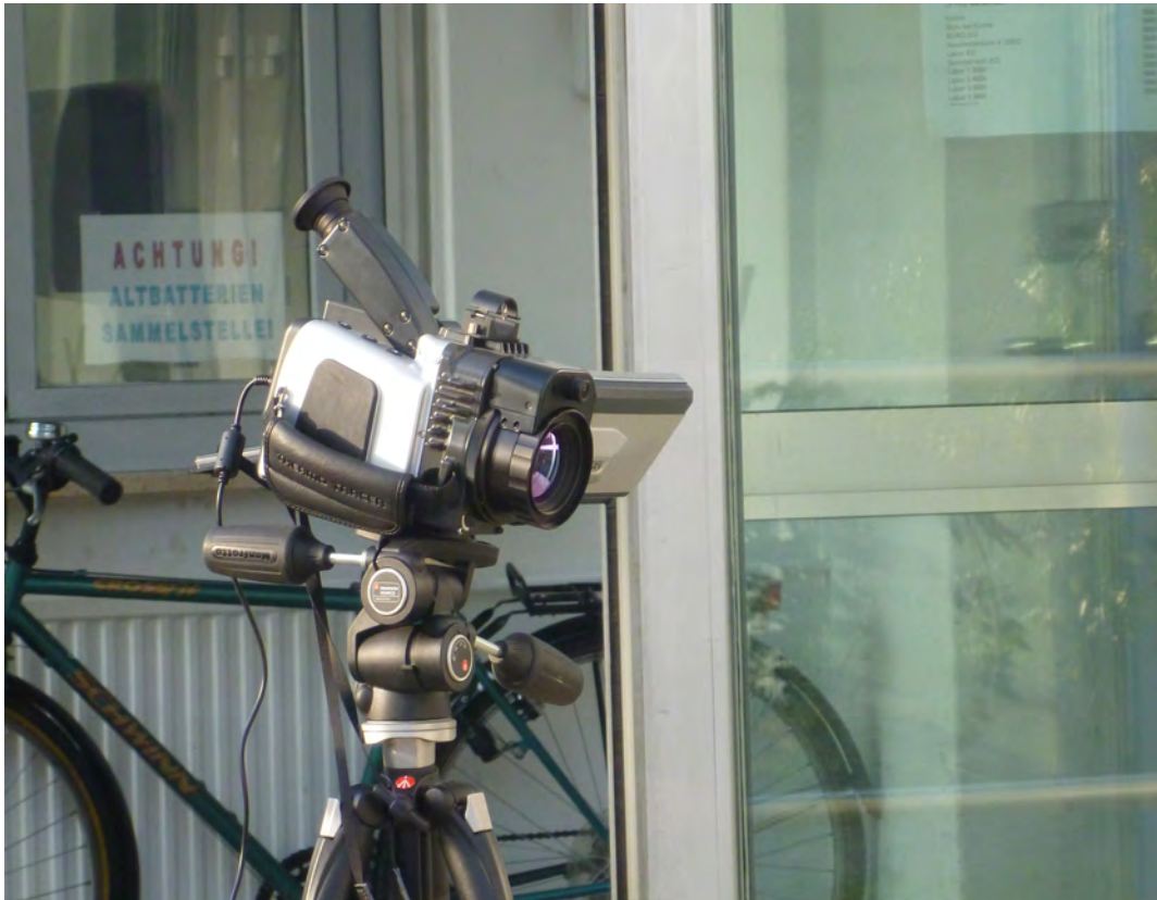
Abb. 29: Versuchsaufbau am 05.11.2011, Thermokamera (NEC/Avio Infrared Technologies)
