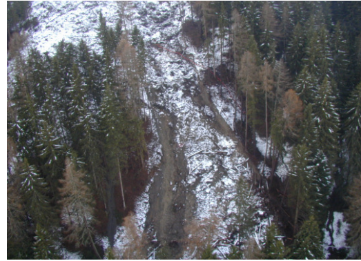
Abbildung 6.6: Orographisch linker Lappen der Rutschung, beidseitig abgesichert und flach talwärts kriechend (Geologisches Amt Südtirol 2002).
