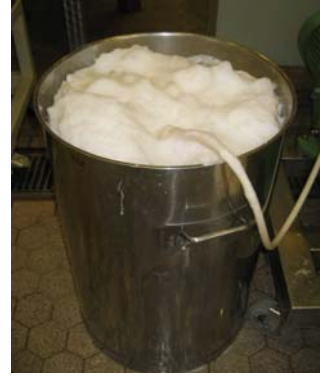
Abb. 7.13: Schaumbildung bei der Zentrifugation
