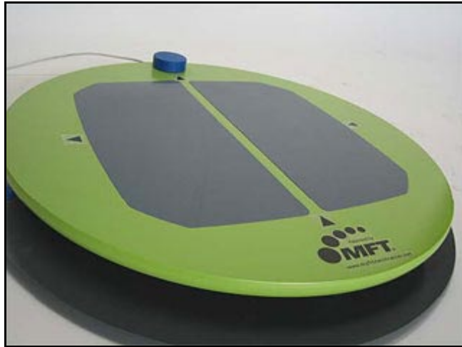
Abb.3: Das Testgerät MFT S3 (Multifunktionale Trainingsgeräte, 2007a)
