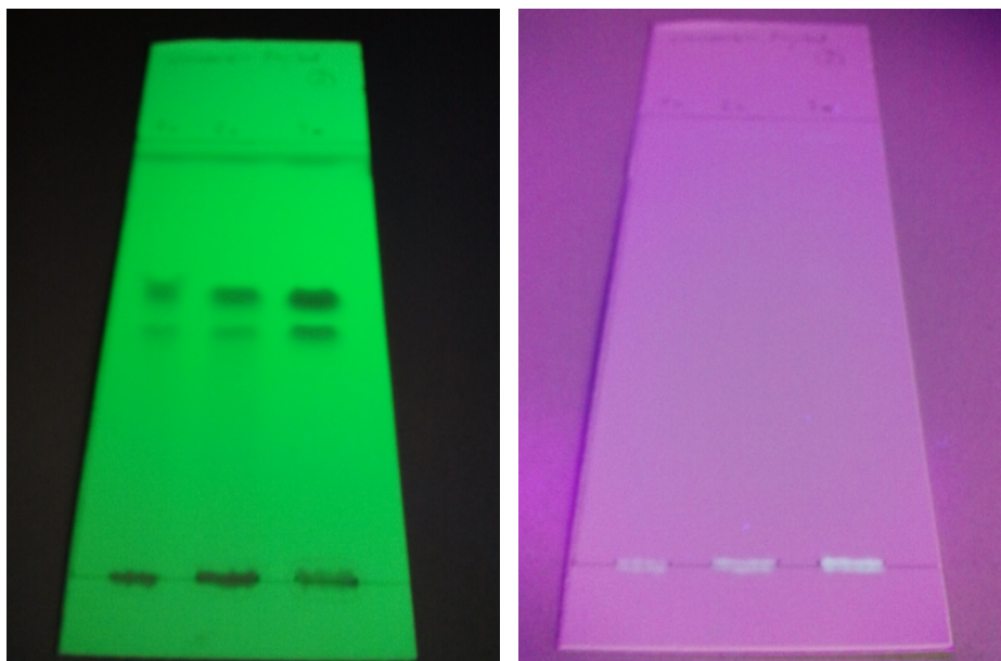
Abb. 18: DC mit Auftrageschema von links nach rechts: 5µl, 10µl und 15µl UV-bestrahlte Cinnarizin-Probeflösung, Fließmittel: Ethylacetat (links: DC bei 254nm, rechts: DC bei 366nm)
