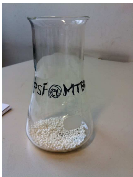
Abbildung 16: Hergestellten Kugeln: PSF@, PSF@CI, PSF@MTBA, PSF@TS
