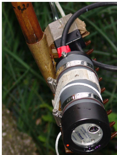
Abb. 20: An einem Rechen befestigte Haardt Fluoreszenzsonde
