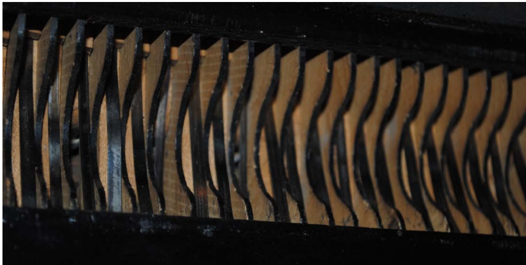
Abb. 45: Federsystem Nr. 1 (ältere Bauweise; Budowitz, Kuritka, Regelstein)
