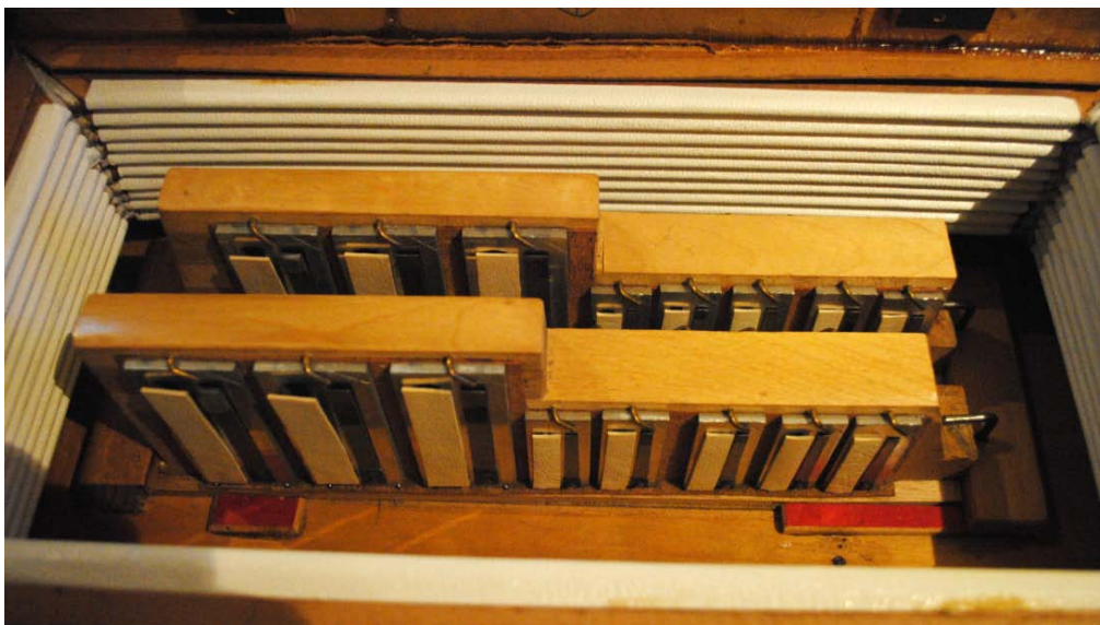
Abb. 47: Kanzellenkörper mit Stimmplatten
