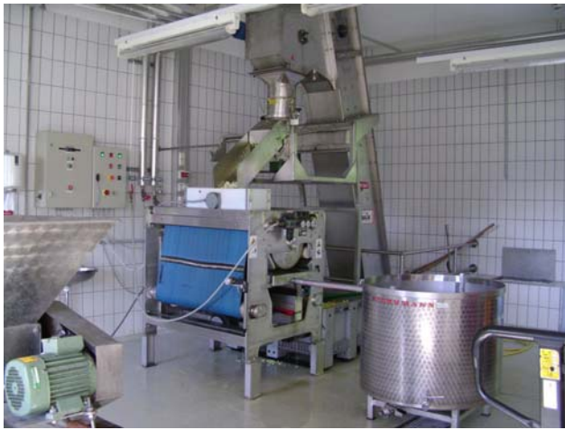
Abbildung 5.12 Rätzmühle (Voran) und Siebbandpresse EW 1002 (V. Stoissier)
