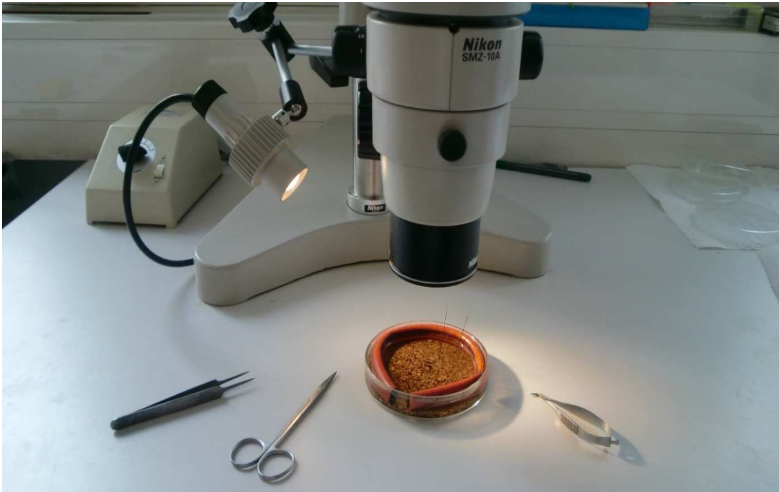
Abbildung. 3.4: Präparierbesteck mit Auflichtmikroskop
