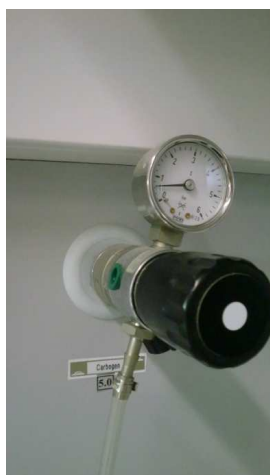
Abbildung 3.11: Originalabbildung der Gasversorgung
